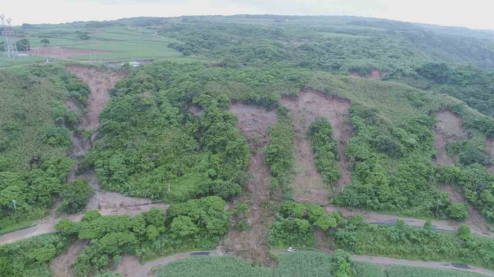
大規模な土砂崩れで通行できなくなった県道 伊実久地区
